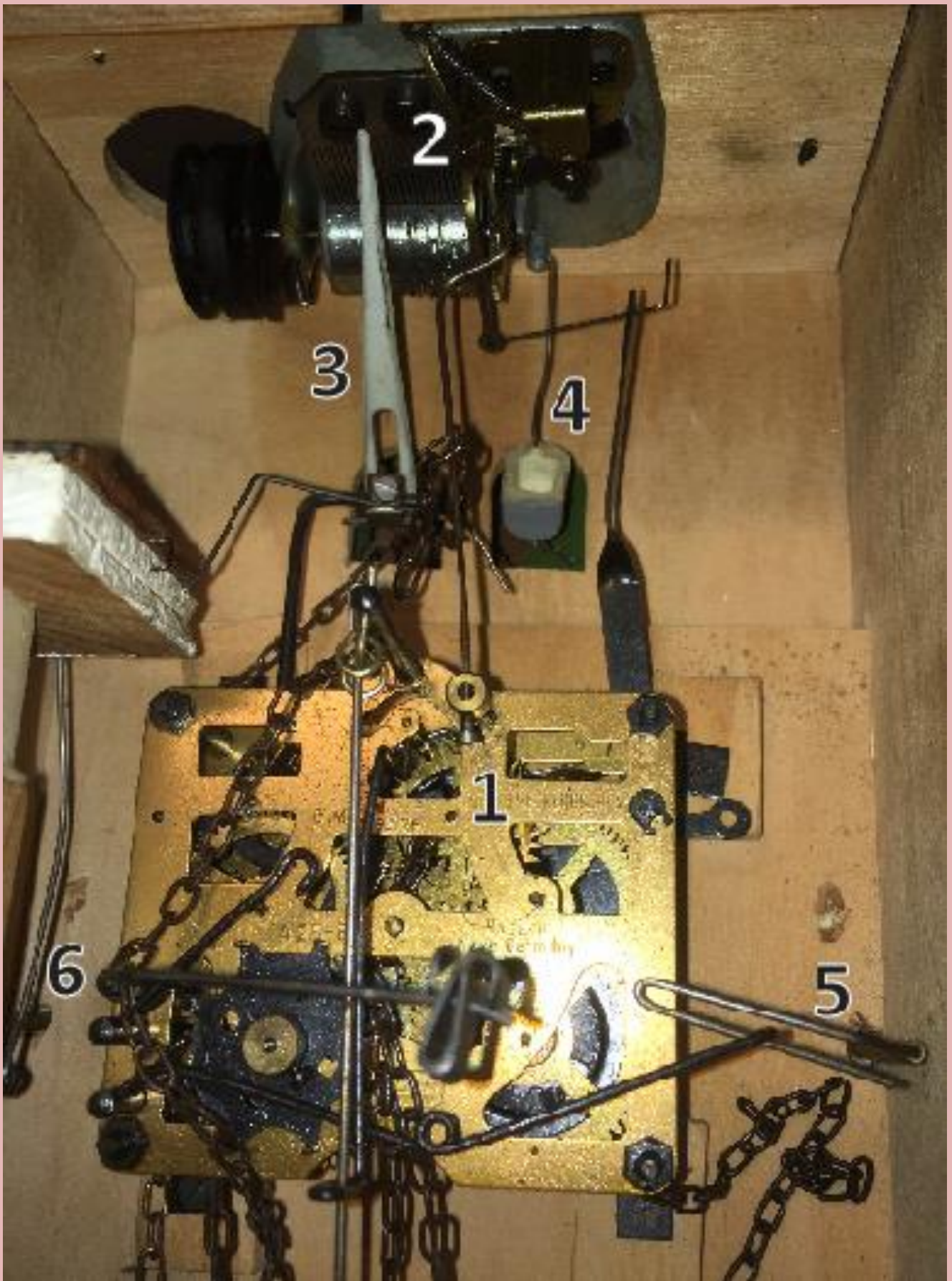
1= il meccanismo, 2=il carillon, 3=cuculo, 4=boccale di birra, 5= leva per il braccio del bevitore di dx, 6= per quello di sn
