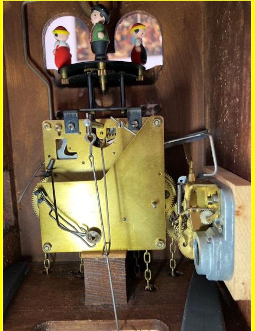
Il retro del cucù con il carillon. Si nota un sostegno del meccanismo all'interno del quale passa una delle catene del carillon.
