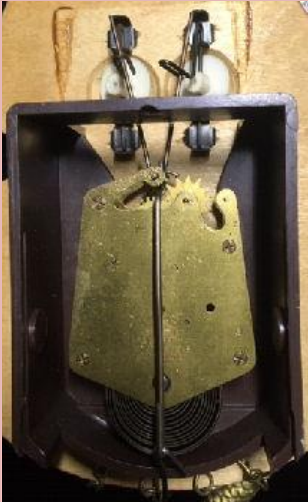
Particolare del meccanismo con movimento occhi
