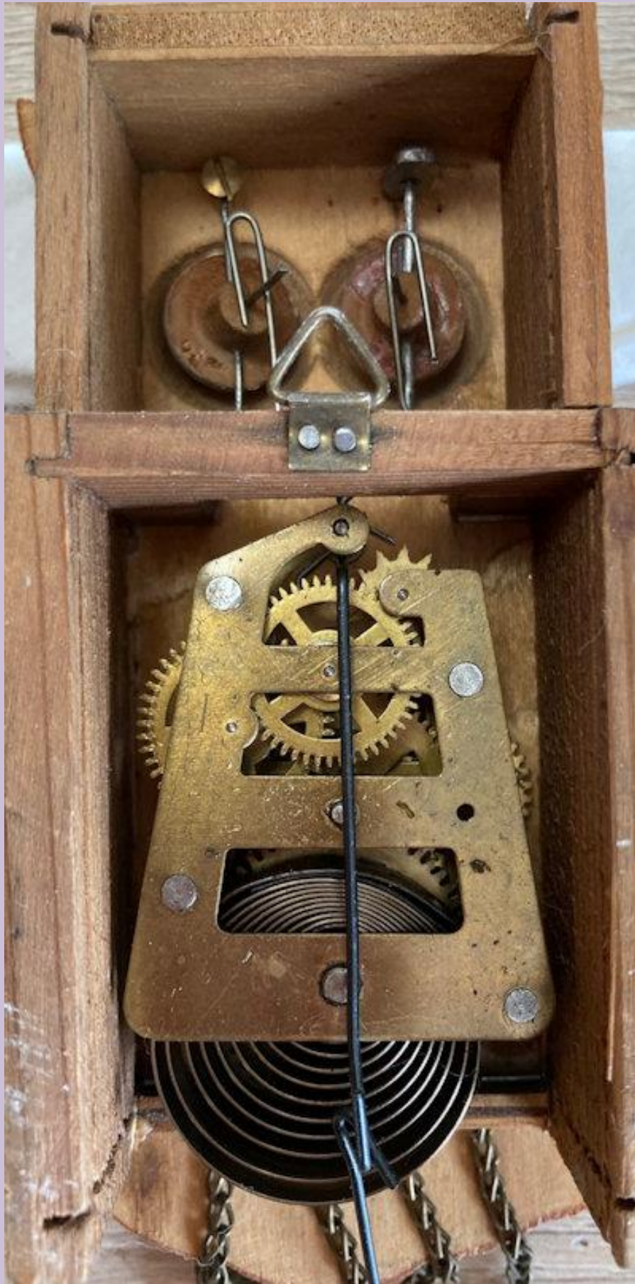
Il meccanismo che comanda Anche il movimento degli occhi
